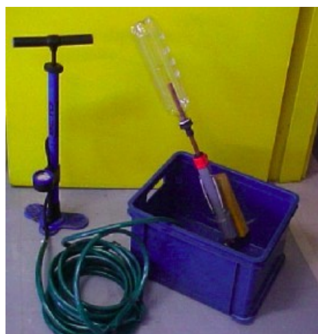
Figure 44 : Lanceur type Lanoë
