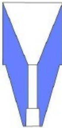
Figure 25 : Coupe d'une réduction de diamètre de tuyère
