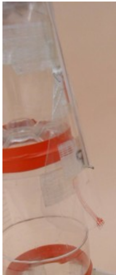
Figure 70 : Volet aérodynamique avec verrouillage par charnière
