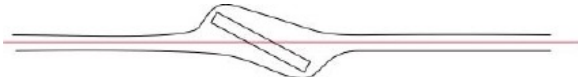
Figure 13 : écoulement de l'air autour d'un plan faisant un angle \alpha par rapport au flux
