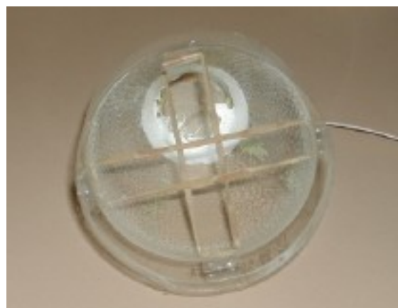
Figure 67 : Croisillon d'élastique pour l'éjection du cône
