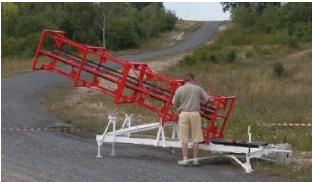
Figure 49 : Rampe CNES pour Fusex
