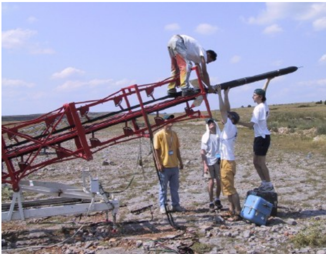
Figure 93 : Mise sur rampe d'une fusée expérimentale
