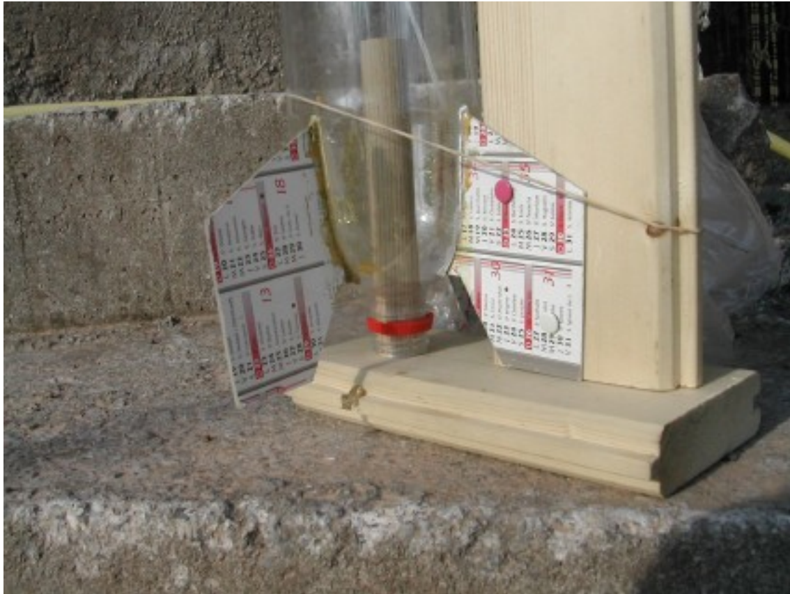
Figure 37 : Une méthode de collage d'ailerons
