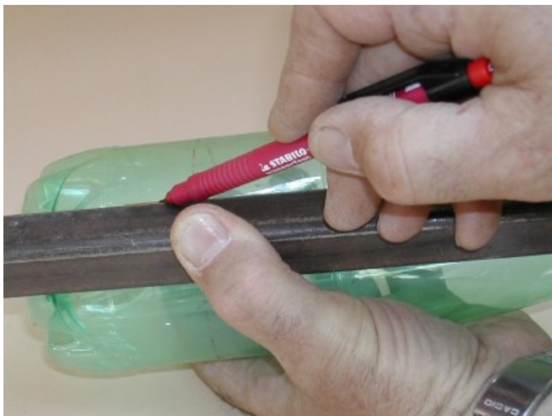
Figure 22 : Traçage à l'aide d'une cornière
